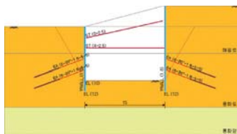
경사 STRUT 설치
