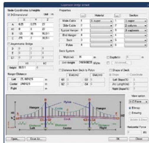
Suspension Bridge Wizard를 이용한 자정식 현수교 모델
