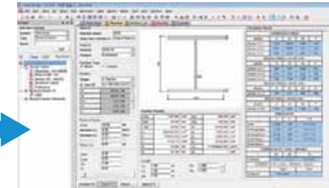
정형단면 Code Checking(Design+)
